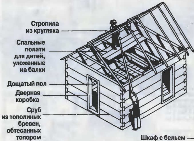
Рис. 1 Конструкция и внутреннее обустройство хижины
